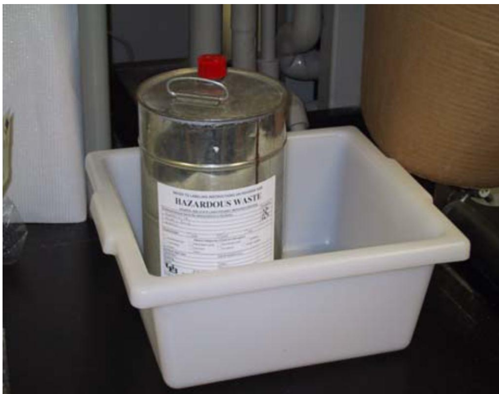
شکل ۸- محفظه ثانویه ظرف پسماند شیمیایی خطرناک
